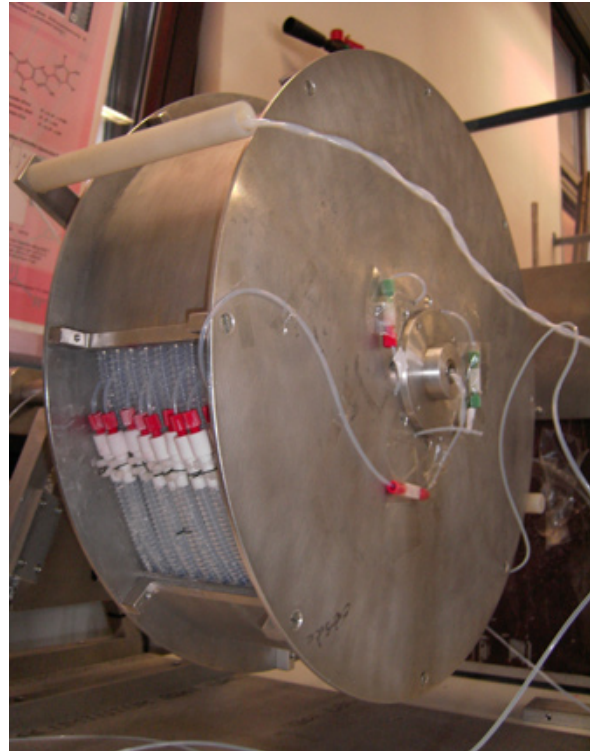
Mithilfe dieses Gegenstromverteilungs-Chromatografen gelang es Lebensmittelchemikern der TU Braunschweig, etwa 900 Milligramm hochreines Procyanidin B1 sowie dieselbe Menge eines oligomeren Procyanidins zu gewinnen und für die Humanstudien zur Verfügung zu stellen.
