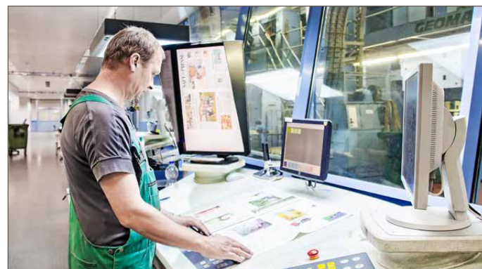
Während des Druckvorgangs werden die Seiten am Kontrollstand minutlich auf Farb- und Schriftqualität geprüft.
